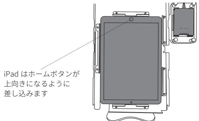
(3) iPad と USB 変換アダプタを接続し、USB 変換アダプタと IC カードリーダーのコネクタを接続します。
