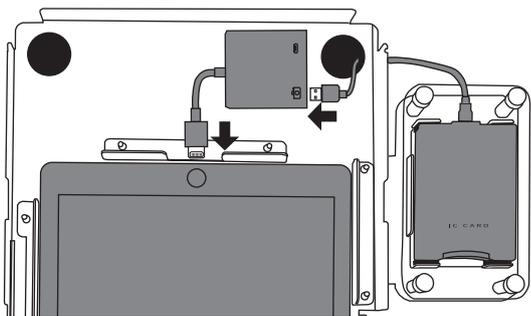
(4) 次に USB 変換アダプタに、iPad の電源コードと電源アダプタを接続します。
